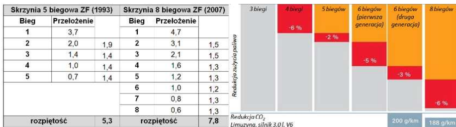
Rys. 5. Zmiany w doborze i rozpiętości przełożeń 5 i 8 biegowej skrzyni biegów i korzyści w zużyciu paliwa
